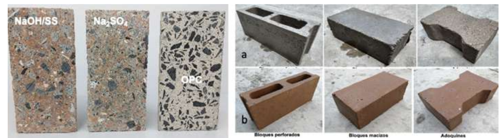
Figura 6. Concretos y elementos prefabricados. a) Elementos a base de OPC; b) elementos a base de concretos activados alcalinamente
