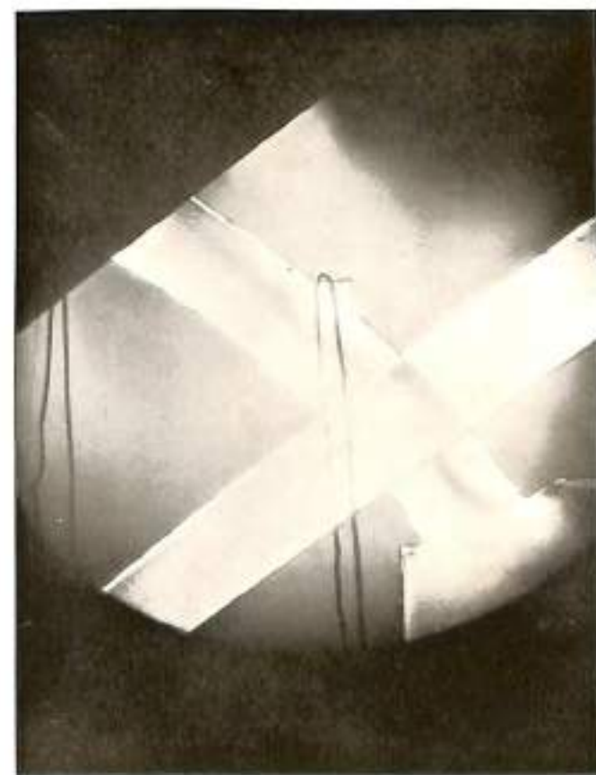
FIGURA 4 La barra transversal pertenece al compensador. La región de sombra que aparece en el compensador sobre el arco, indica que el esfuerzo de tracción aplicado al compensador produce exactamente la extinción de la luz en esa región.
