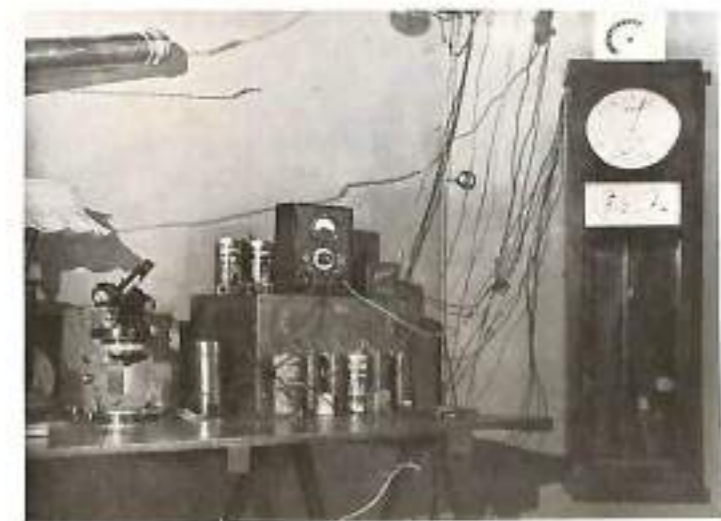
Péndulo (de la Synchronome Co. Ltd.) sincronizado con el "Short", que se encuentra en el jardín, y detalles de su instalación: corrector magnético, relevo para envío de señales etc. (Casilla meridiana - Observatorio Astronómico)
