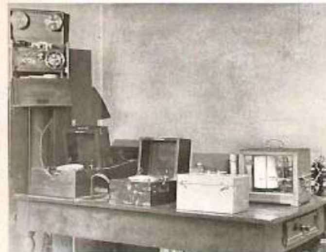
Detalles de los cronómetros de tiempos sidereo y medio y de los cronógrafos registradores. (Casilla meridiana - Observatorio Astronómico)
