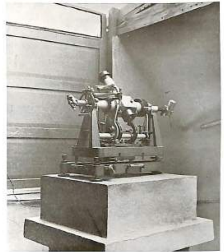
Anteojo de pasos Hayde (tipo Bamberg), con escala micrométrica especial para el método de Talcott. (Observatorio Astronómico)
