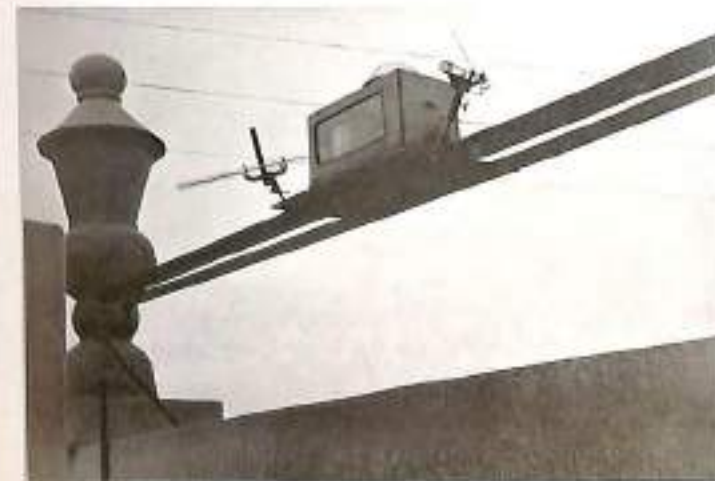
Aclímetro registrador Fuess, con termómetros conjugados. (Azotea del Observatorio Astronómico)
