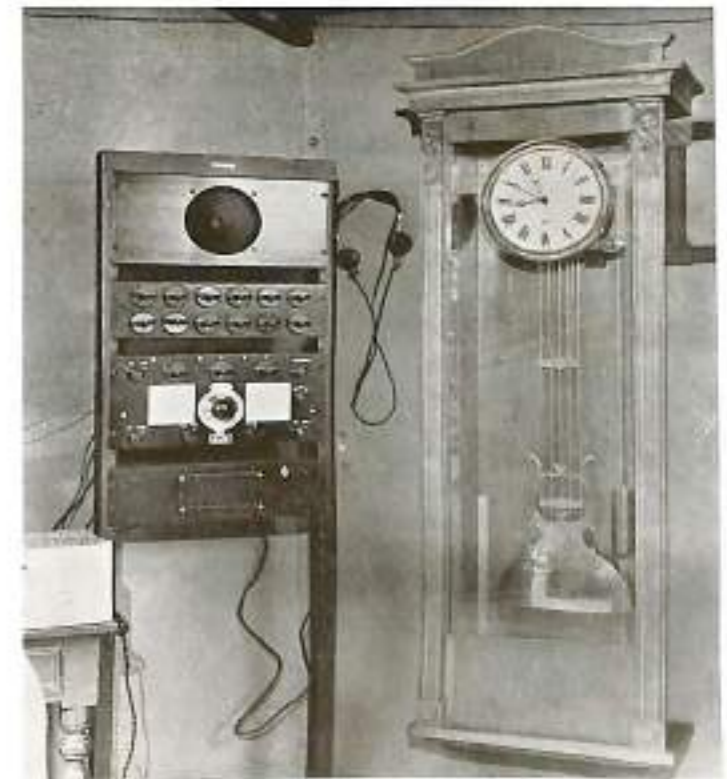
Péndulo sidereal y aparato radiotelegráfico para el recibo de señales horarias. Casilla meridiana (Observatorio Astronómico)
