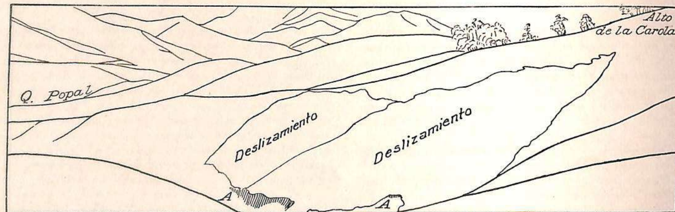
Figura 6.—Croquis explicativo del panorama de la figura 3, de la lámina II. A, erosión de la quebrada, causante de los deslizamientos.
