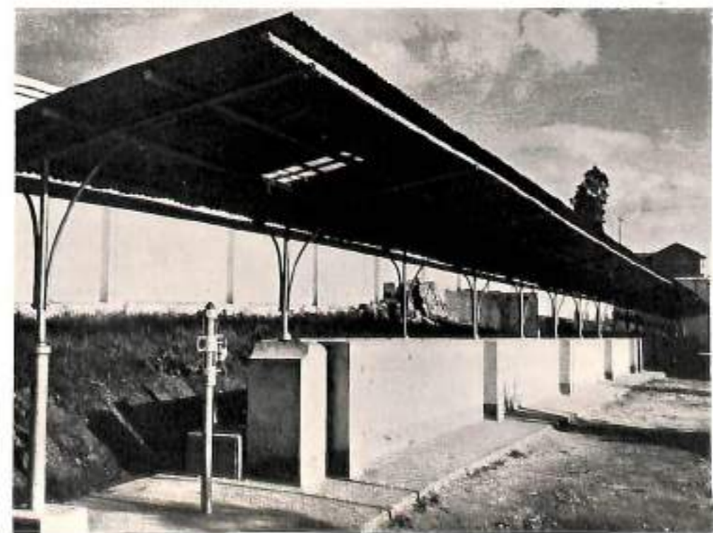
Base de 50 metros para el patronamiento de las cintas de inviar usadas por el Instituto, con reparo intermedio para comparac cintas de 20 y 30 metros.
