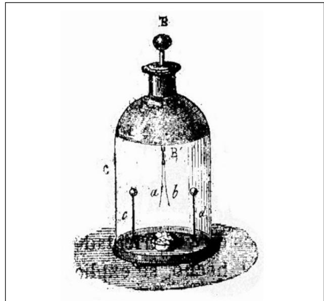
**Figura 2.** Electroscopio para determinar la naturaleza de la electricidad. Tomado de: <http://www.librosmaravillosos.com/laelectricidadysusmaravillas/index.html>
