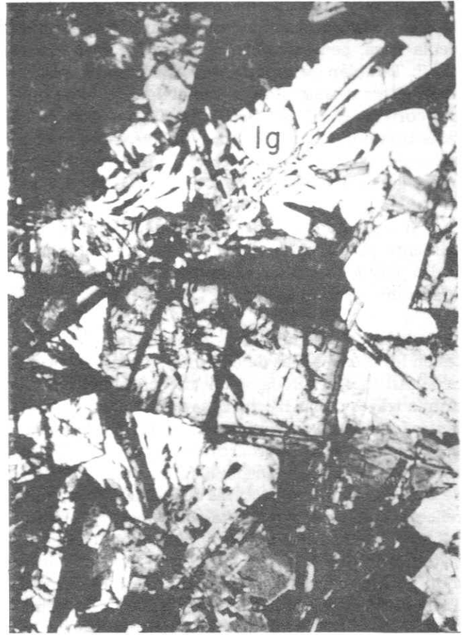
Figura 4. Gabro poikilitico con intercrecimientos gráficos (Ig) de piroxenos y plagioclasas cálcicas. A = 4x Nícoles cruzados.
