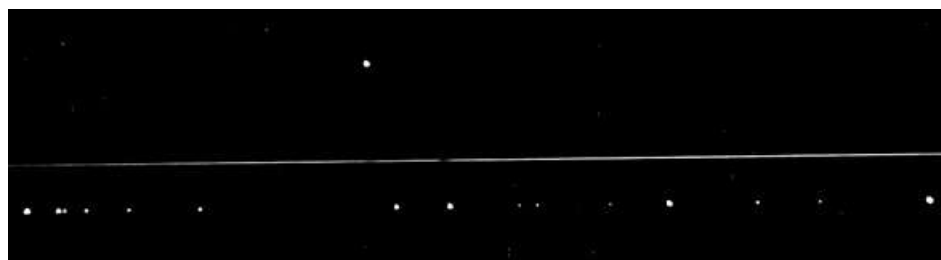
Figura 2. Espectro de Algol que abarca aproximadamente de 443 a 453 nm. Se emplean tres fibras ópticas: Arriba, un espectro de Helio que contiene solo una línea de emisión a 447 nm; en el centro, el espectro de la estrella que muestra la línea de absorción de He I y la línea de Mg II a 448 nm; la línea inferior muestra una serie de líneas de Th y Ar.
