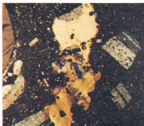
Fotografía 24. Xenolito de caliza en pórfido riolítico. Microfotografía (Nicoles Cruzados). R 8093 F1
