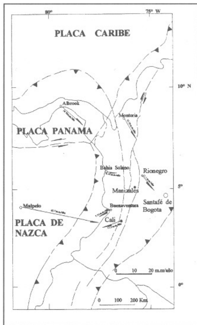
Figura 3. Vectores de desplazamiento de las placas tectónicas en la esquina noroccidental de Suramérica, obtenidos a partir de mediciones geodésicas (G.P.S), realizadas en el marco del Proyecto CASA entre 1991 y 1996 (Mora, 1995 y Mora et al, 1997).
