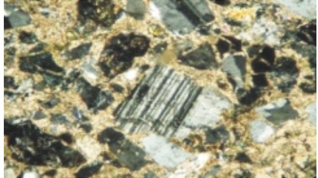
**Foto sección delgada 4.** Al centro, cristal de plagioclasa labradorítica y entre otros del mismo feldespato y algunos fragmentos de una roca afanítica y de cuarzo.
