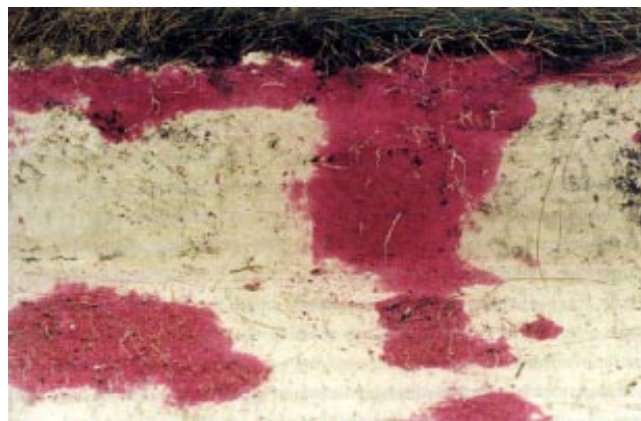
Figura 7. Vías de flujo preferencial (áreas rojas) en suelos arenosos homogéneos de dunas de Holanda. Foto tomada de Dekker (1998).
