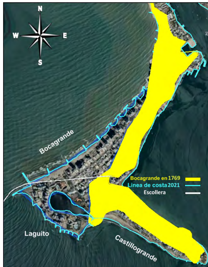
Figura 11. En amarillo, las penínsulas de Bocagrande y Castillo Grande calculadas a partir de los planos de Arebalo de 1769 al inicio de la construcción de la escollera (línea blanca) superpuestas a una imagen de 2021 tomada de GoogleEarth®, cuya línea de costa (en azul) resalta el área de terreno ganado principalmente por la construcción de la escollera y de forma secundaria por las baterías de espolones posteriores, cuyos tamaños son cortos en comparación.
