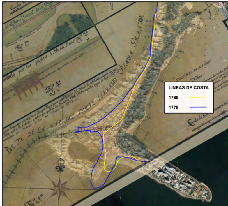
Figura 7. Detalles de la construcción de la escollera en el costado de Bocagrande sobre el plano de Arebalo (1778) superpuesto a una imagen satelital actual. Obsérvese el cambio de la línea de costa medido por los constructores desde 1769.
