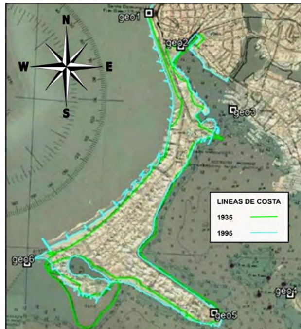
Figura 10. Análisis de la línea de costa empleando las cartas náuticas de la Armada de los Estados Unidos de 1935 y la de 1995. En esta figura es evidente la franja de arena que resultó de la construcción del grupo de espolones en la década de 1960 y la estabilización de El Laguito en la forma definitiva.
