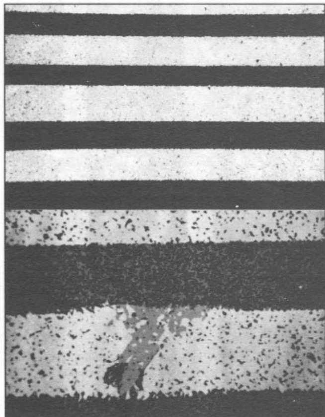
Figura 8. Microfotografía de una multicapa \text{Al}_2\text{O}_3/\text{TiO}_2 tratada térmicamente a 1325^\circ\text{C} por 20h, mostrando la formación de \beta\text{Al}_2\text{TiO}_5 en la capa de titania.
