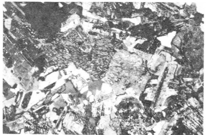
Figura 10. SECCION DELGADA DE DIORITA. (Foto: A. Fandiño)
