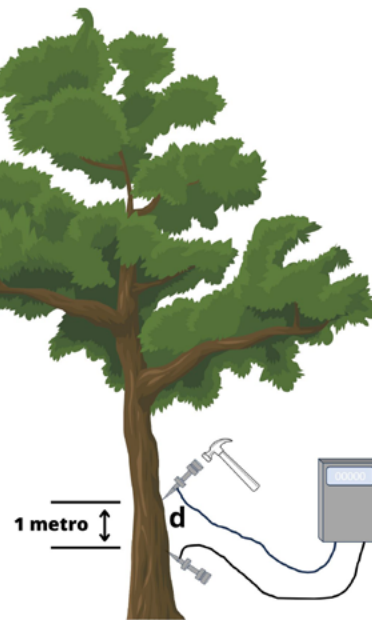
Figura 1. Esquema metodológico de la medición de MOE d en árboles de G. arborea en pie
