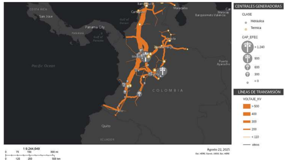
Figura 5. Mapa de las centrales generadoras y líneas de transmisión eléctrica en Colombia. Los círculos señalan las centrales generadoras de acuerdo a su capacidad efectiva y en naranja se muestran las líneas de transmisión según el voltaje. Fuente: DNP, 2010. Creado en ArcGIS para esta publicación.
