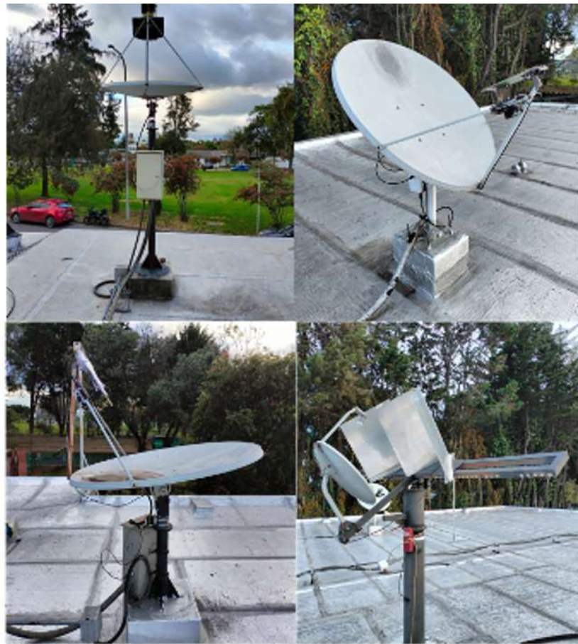
Figura 10. Equipos desarrollados en el Observatorio Astronómico Nacional de Colombia. Los equipos en las imágenes superiores e inferior izquierda corresponden al PhARaON, y el de la imagen inferior derecha corresponde al IMFR11GHZ (Cortesía OAN).
