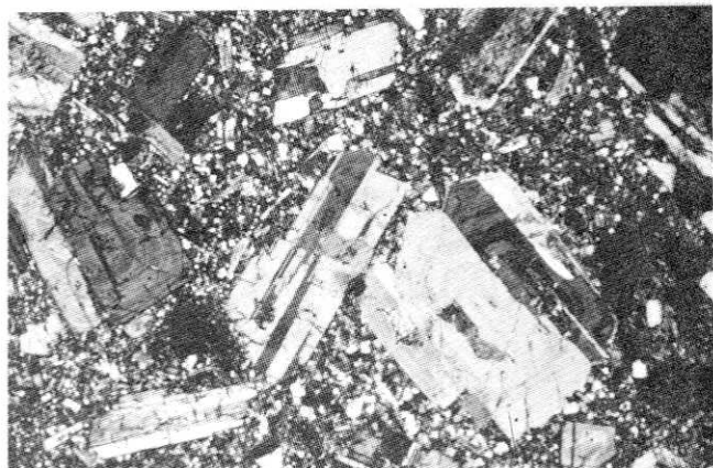
Figura 13. SECCION DELGADA DE ANDESITA. Cristales de plagioclasa zonada con bordes de andesina y núcleo de labradorita; anfíbol; esporádicamente piroxeno. La muestra presenta alteración hidrotermal con presencia de carbonatos y matriz de microlitos principalmente de plagioclasa. (Foto: A. Fandiño).
