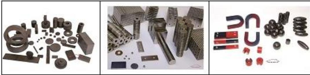
**Figura 18S.** Diferentes tipos de IPs para pequeñas aplicaciones: imanes de hexaferritas (Izq.), imanes de Nd<sub>2</sub>Fe<sub>14</sub>B (Cent.), e imanes de alnico y cerámicos.
