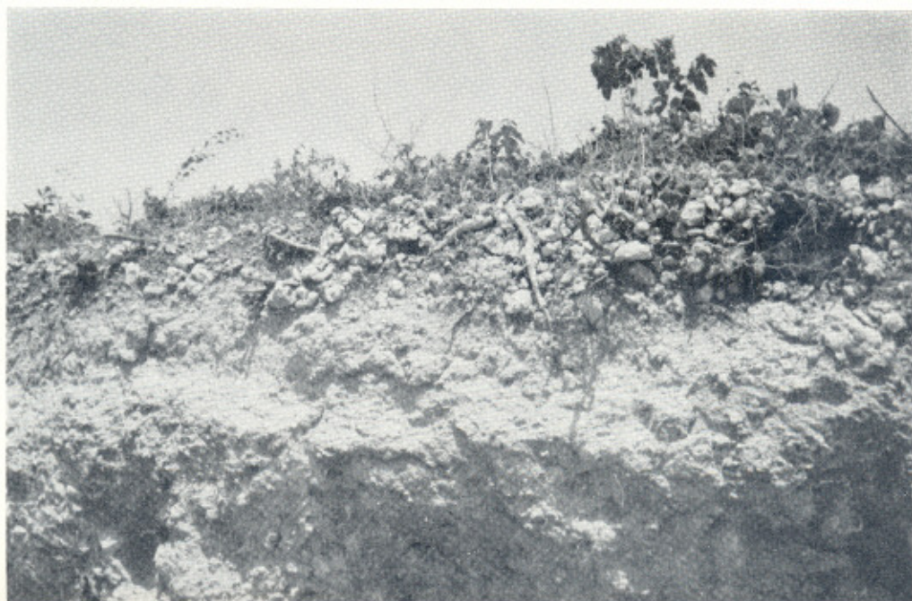
Foto N° 2. Perfil de un corte entre las nuevas urbanizaciones "Ciudad Jardín" y "Nuevo Horizonte" en la parte más alta de Barranquilla, a 120 metros sobre el nivel del mar. El suelo delgado es residual pues tiene origen en la disgregación de la caliza blanqueca (y de poca dureza) cuya matriz se ve abajo. Esta es muy escasamente coralífera.
