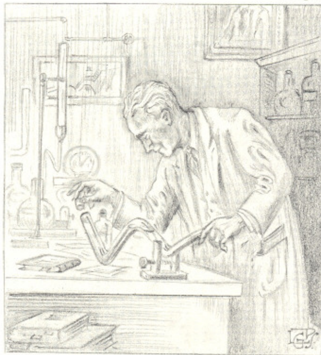
7-En la Universidad de Minnesota, el Profesor W. H. Emmons, comprueba los resultados de los experimentos de G. A. Thiel (1920), relativos a la conducta del petróleo y el gas en tubos de vidrio que simulan anticlinales y sincinales (1920).
