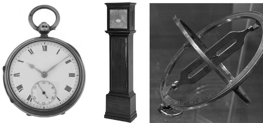
Figura 1. Instrumentos de medida del tiempo de finales del siglo XVIII y comienzos del XIX. Izquierda: cronómetro de la casa John Arnold & Sons; centro: reloj de péndulo de Graham; derecha: reloj de sol universal de Dollond.
