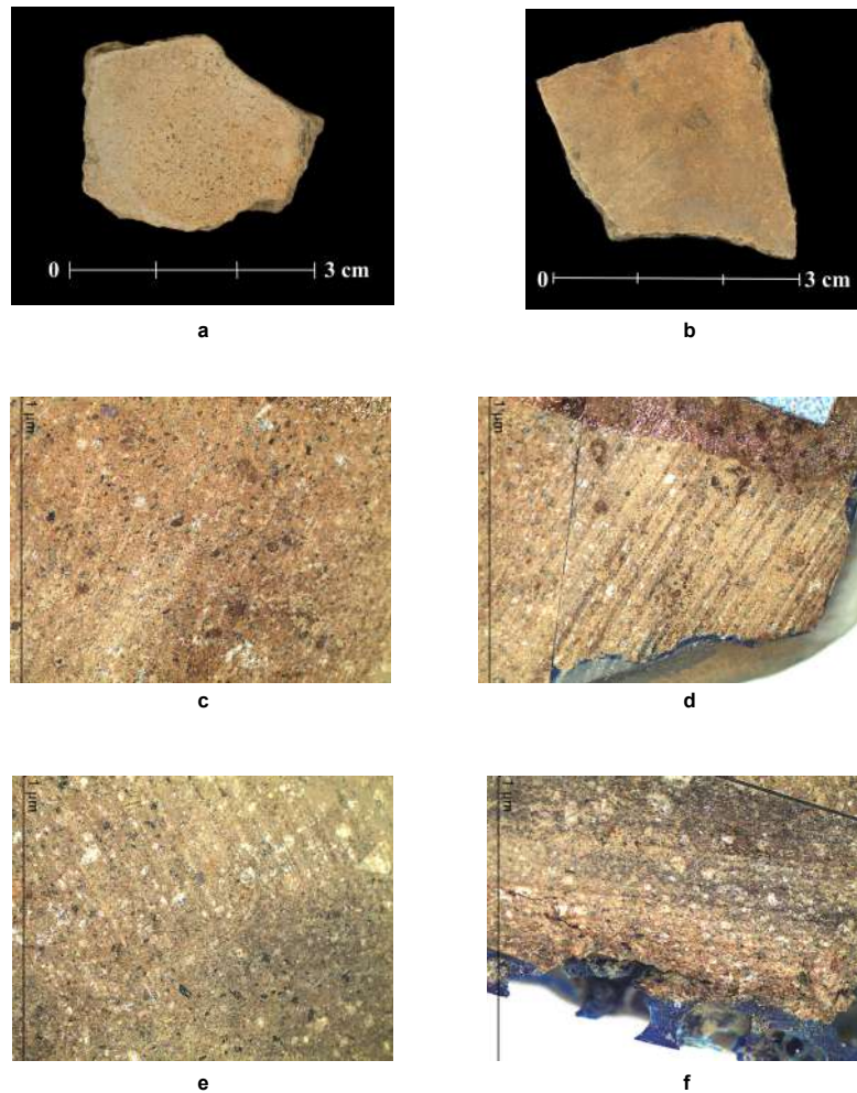
Figura 4. Cerámica: BOM5 C1-I ( a ); BOM5 C1-II ( b ): macrofotografías ( a,b ); estereofotografías ( c,d,e,f ). En ambos fragmentos se identifican granos de feldespato, anfíbol, cuarzo y fragmentos de roca ( c,d ). En la sección transversal del fragmento II ( f ) se observa una capa gris oscura y otra café, lo que muestra mayor contenido de arenas medias y gruesas en la zona oscura.
