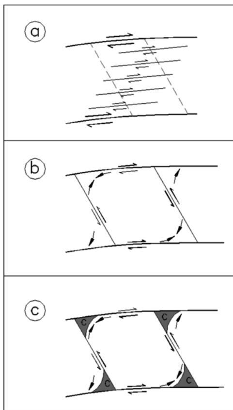
**Figura 3.** Estilo estructural de la cuenca Baja Guajira. Representación esquemática de una cuenca transrotacional. a) Sistema de fallas de rumbo de componente dextral, que generan fallas paralelas y de cizalla oblicuas, b) detalle de posibles esfuerzos al interior del esquema donde se indica el movimiento, c) zonas de interés donde se concentran esfuerzos compresivos. Las fallas en sentido E-W podrían corresponder a las fallas de Cuiza y Oca.
