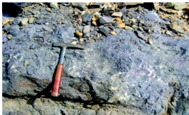
Foto 2. Basalto de color negro azulado compuesto principalmente por labradorita y clinopiroxeno. Constituye la base de la secuencia de sedimentitas calcáreas Cretáceas. Carretera que conduce de Distracción a Caracolí.
